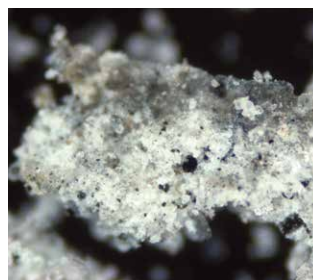
Skrystalizowany iCapsol, w którego kapsułkach zamknięte są cząsteczki brudu
